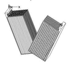
A : SeparatorsB : ContainerC : Post terminalD : Plates
